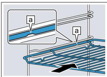
Blech z. B. Universalpfanne oder Backblech Das Blech mit der Abschrägung
