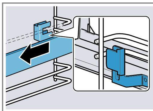
4. Die Auszugsschiene entfernen.
