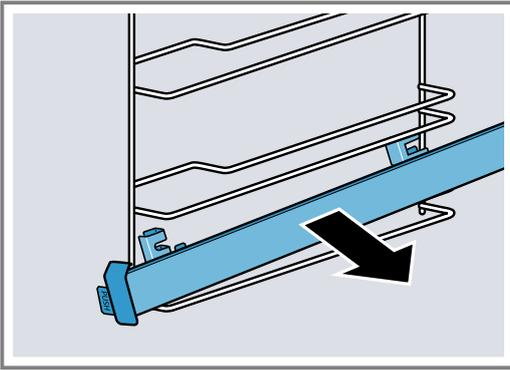
5. Die Auszugsschiene reinigen.
