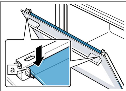
5. Die Gerätetür öffnen und Türdichtung einhängen.
