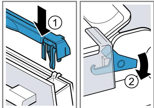
✓ Die Sperrhebel sind zugeklappt. Die Gerätetür ist gesichert und kann nicht ausgehängt werden.
