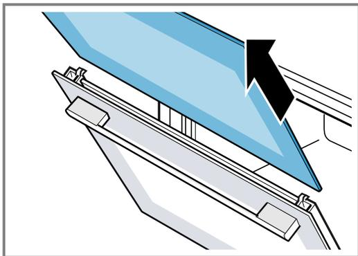
7. Die Gerätetür öffnen und Türdichtung abnehmen.
