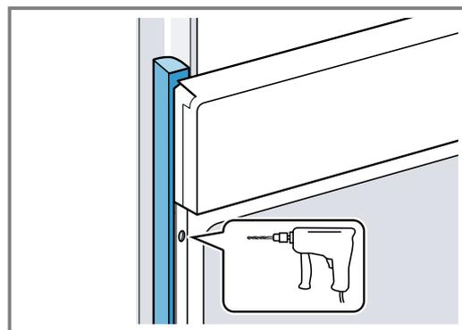
4. Das Gerät mit adäquater Schraube befestigen.
