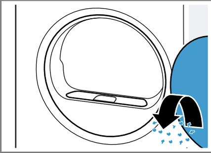
3. Das zweiteilige Flusensieb entfernen.
