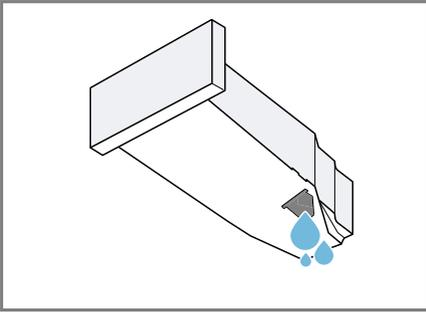
Prüfen Sie regelmäßig den Filter des Kondenswasserbehälters und reinigen Sie einen verunreinigten Filter. → Seite 43
