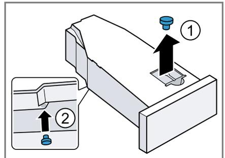
2. Den Filter im Kondenswasserbehälter reinigen.
