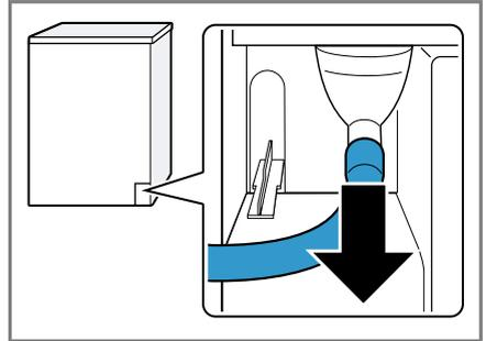
Der Kondenswasserschlauch ist werkseitig am Stutzen angeschlossen.
