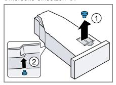
2. Den Filter im Kondenswasserbehälter reinigen.
