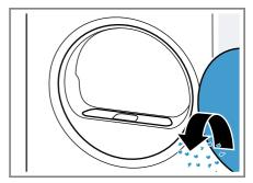
Das zweiteilige Flusensieb entfernen.
