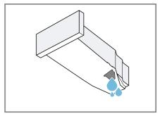
Prüfen Sie regelmäßig den Filter des Kondenswasserbehälters und reinigen Sie einen verunreinigten Filter. → Seite 46 Stellen Sie sicher, den Kondenswasserbehälter vor dem Betrieb des Geräts einzuschieben.
