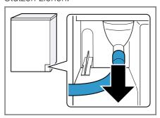
Der Kondenswasserschlauch ist werkseitig am Stutzen angeschlossen.
