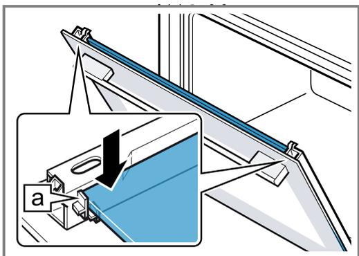
5. Die Gerätetür öffnen und Türdichtung einhängen.
