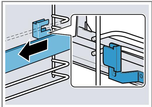
4. Die Auszugsschiene entfernen.
