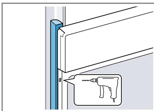
4. Das Gerät mit adäquater Schraube befestigen.
