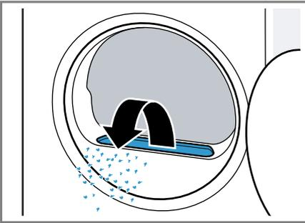
Stellen Sie sicher, dass keine Flusen in den Luftkanal fallen.
