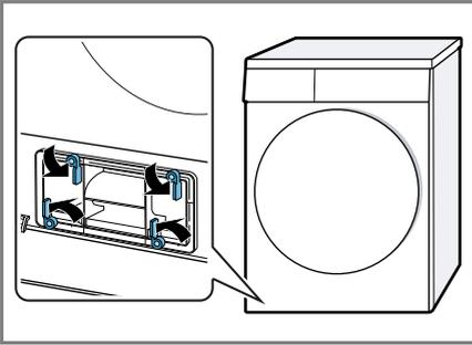
3. Die Wärmetauscherabdeckung am Griff herausziehen.
