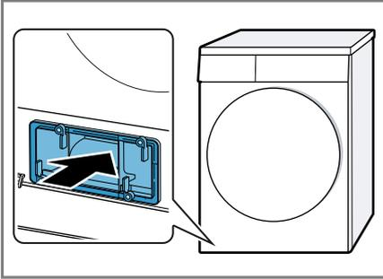
2. Die Hebel der Wärmetauscherabdeckung schließen.
