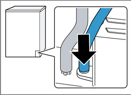
4. Den Wasserablaufschlauch in die Schlauchführung einsetzen.
