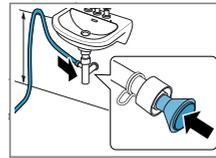
Die Anschlussstelle mit einer Schlauchschelle (12-22 mm) sichern. Den Wasserablaufschlauch mit einer Schlauchführung in minimal 80 cm und maximal 100 cm Höhe befestigen.
