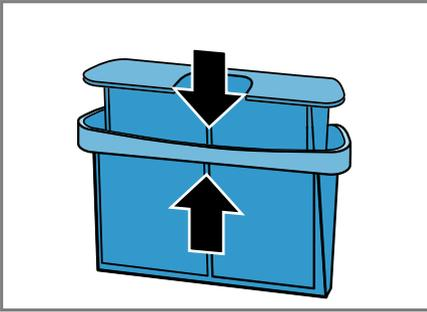
10. Das zweiteilige Flusensieb einsetzen.
