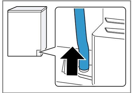
Der Kondenswasserschlauch ist werkseitig am Stutzen angeschlossen.
