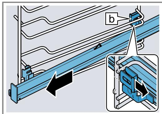
4. Die Auszugsschiene entfernen.
