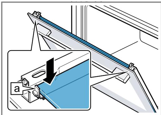
5. Die Gerätetür öffnen und Türdichtung einhängen.
