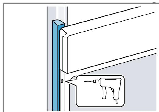
3. Gerät mit adäquater Schraube befestigen.
