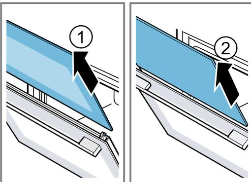
8. Die Gerätetür öffnen und Türdichtung abnehmen.
