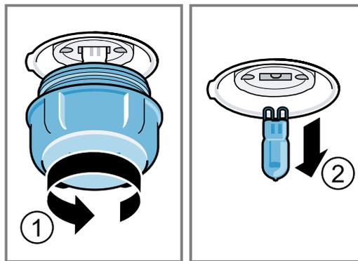
4. Die neue Halogenlampe einsetzen und fest in die Fassung drücken. Auf die Stellung der Stifte achten.
